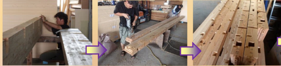
工場に搬入された構造材を加工していきます。
