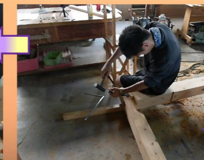
刻み加工が終わったら仮組ををしてぴったり納まるように微調整を行います。
