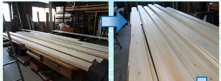
工事にかかる前に工場に納品された床板を選別し、加工します。
