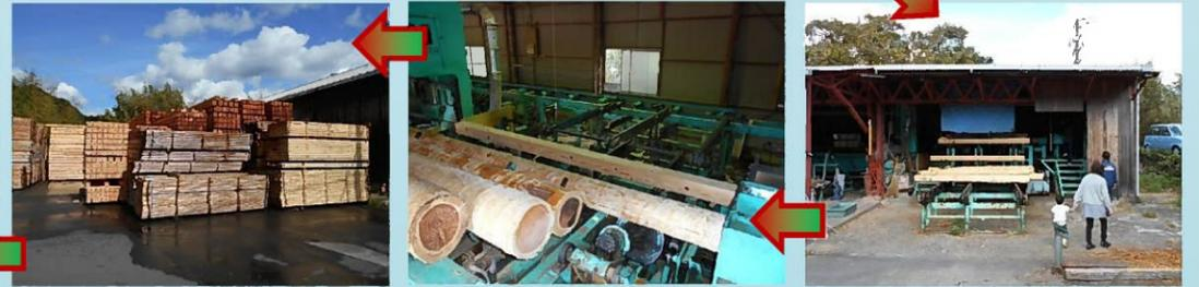
皮を剥いだ原木を製材機に投入し、角材や板の製品に加工し、乾燥させます。
