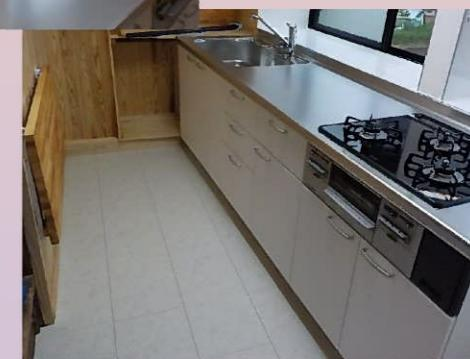
排水管を新たに取り替えたので水漏れの心配もなくなりました。タイル土間から断熱材を充填した床へ変えたことで冬の寒さ対策もできました。
