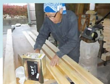
小幅板を一枚ずつ加工しています。 壁に使用する無垢材には、自然塗料いろはを塗布します。
