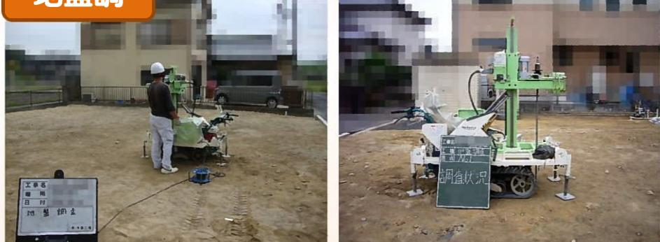
地盤調査する試験の方法は、スウェーテン式サウンディング試験といいます。図面を基にいくつかのポイントに印を付け、調査を行います。調査方法は、調査機にスクリューポイントをロッドの先端に取り付け、調査ポイントに設置し、ロッドに荷重を掛け、地盤に沈む状態を測定し記録し、測定終了後、ロッドを引き抜き、付着している土の状態や異常の有無を調べ、地盤調査は終了です。
