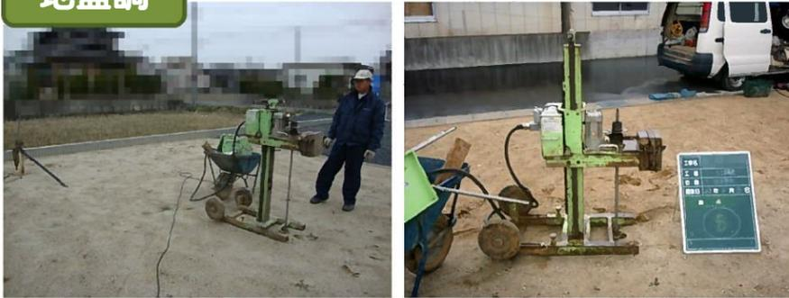
地盤調査する試験の方法は、スウェーデン式サウンディング試験といいます。図面を基にいくつかのポイントに印を付け、調査を行います。調査方法は、調査機にスクリーポイントをロッドの先端に取り付け、調査ポイントに設置し、ロッドに荷重を掛け、地盤に沈む状態を測定し記録し、測定終了後、ロッドを引き抜き、附着している土の状態や異常の有無を調べ、地盤調査は終了です。
